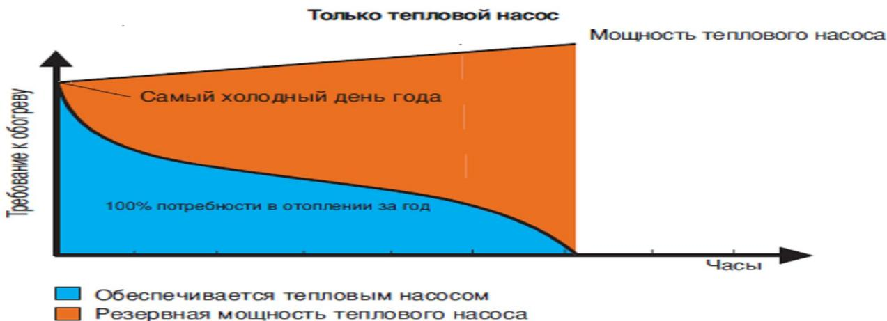
**Рис. 5в. Теплоснабжение тепловым насосом без резервного источника тепла - моновалентный режим работы. Наименее эффективное использование теплового насоса**
