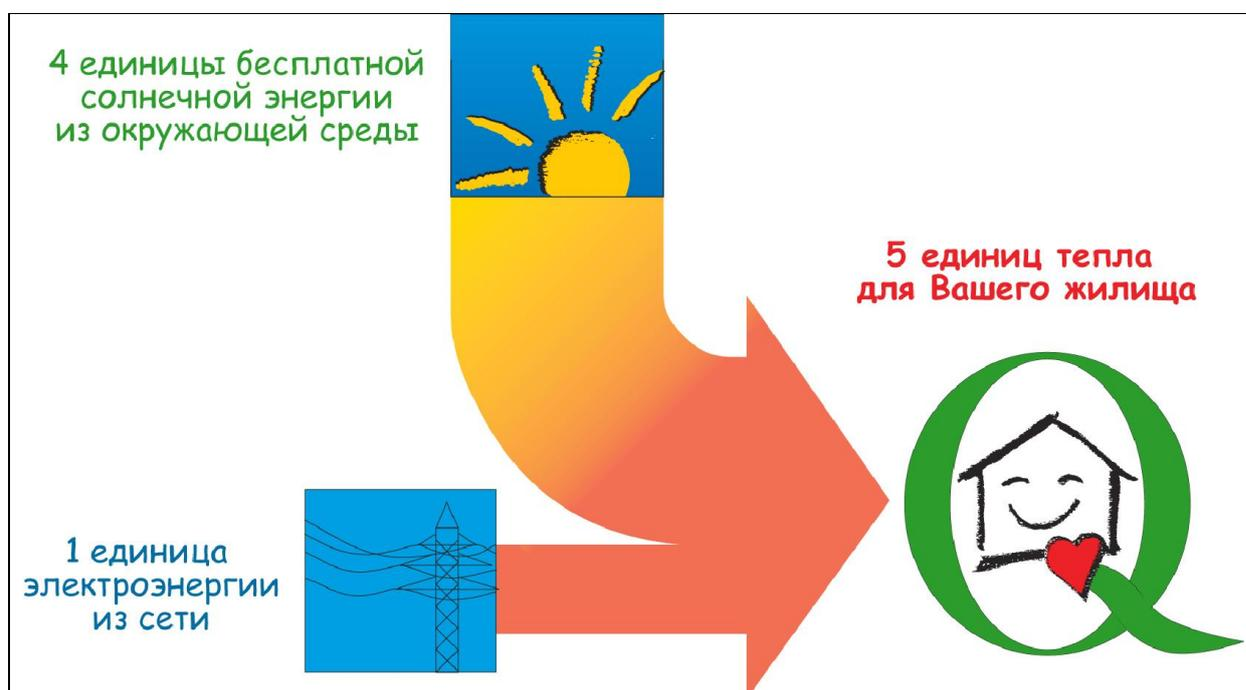
В зависимости от задачи текущего момента тепло можно транспортировать как внутрь помещения, так и на улицу, но во втором случае тепловой насос будет выполнять уже функцию *кондиционера*. Поэтому-то функционально тепловой насос представляет собой **универсальный бытовой агрегат типа «два в одном»**, т.е. - и котел, и кондиционер, что позволяет экономить на покупке одного из агрегатов.
